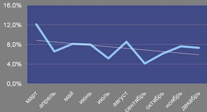
Коэффициент техпростоев линий розлива в ПЭТ.
