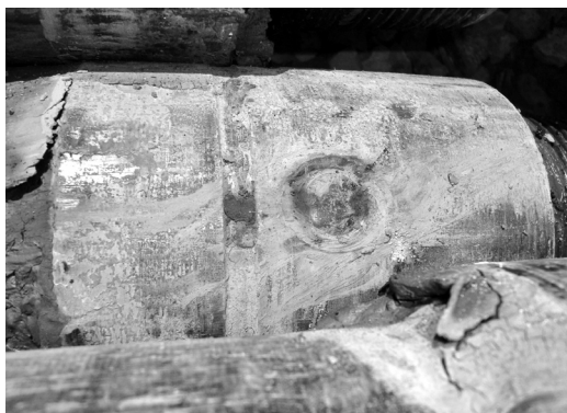
Рисунок 5. Крепление RFID-меток на бурильной трубе.
