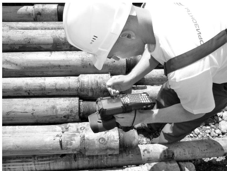
Рисунок 4. Считывание информации с RFID-меток.
